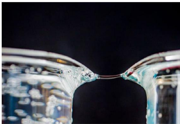
Med en højspændingsforsyning og to elektroder kan man danne en vandbro, der svæver i luften (Illustration: Christian Carlsson)
